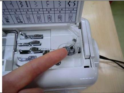
**Step 8: Disengage the clutch**
